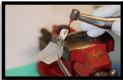
Figur 2. Tann plassert i skrustikke. Papir holdes under for oppsamling av ekstrudert materiale.
