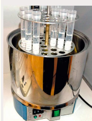
Figur 2: Disker nedsenket i fortynnet eddiksyre i polypropylenrør, plassert i et termobad med druekjerneolje ved en temperatur på 80 °C.
