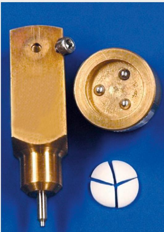
Figur 1: Utstyr brukt i den bi-aksiale nedbøyningstesten og en disk etter brudd.
