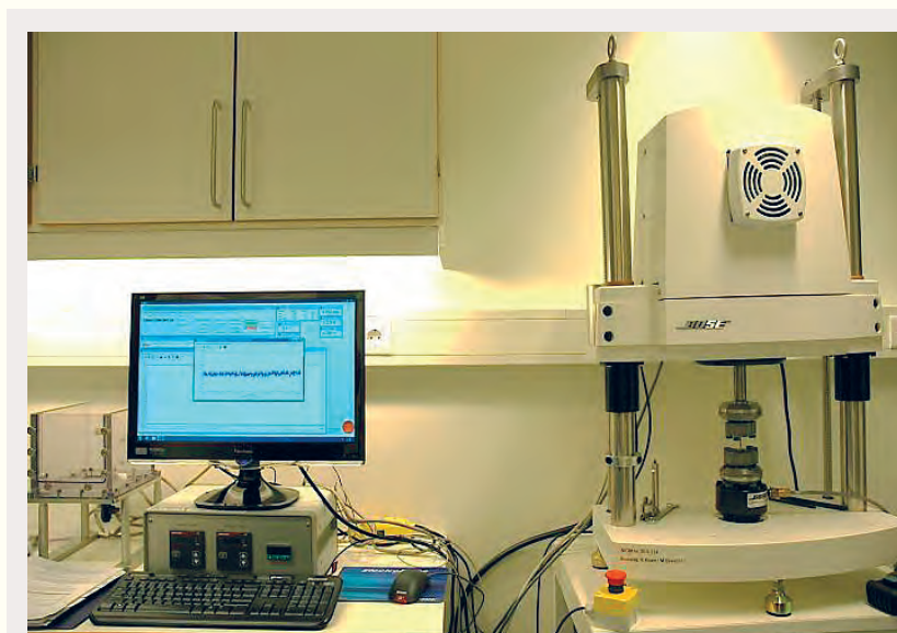
Figur 1. NIOMs nyanskaffede elektrodynamisk utmatningsinstrument (BOSE ElectroForce 3330 N) kan simulere at restaureringer påvirkes av tyggekrefter, tørt eller i vannbad ved 37 °C. Foto: Ketil Kvam.
