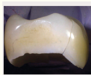
Figur 6. Kronekanter. Eksempel på en to-lags zirkoniakrone, frakturert i klinisk bruk etter mindre enn 3 år. En ser tydelig at det er flere mindre avskallingsdefekter i kronekanten. En av disse er bruddanvisningspunkt for den totale frakturen som har delt kronen i to.
