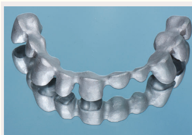
Figur 1. Eksempel på et broskjelett fremstilt ved selektiv lasersmelting (SLM) av kobolt-kromlegering. Foto: Harald Gjengedal.
